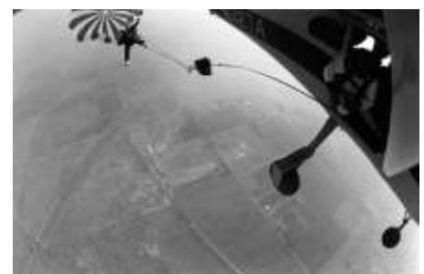
Резерва која се отворила повлачи падобранца са папучице. Главна купола закачена гуртном ће се тек отворити
